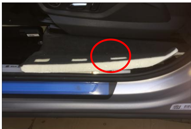
左踏板电机布线：掀开驾驶室垫脚海绵后，可看见车底穿线孔
