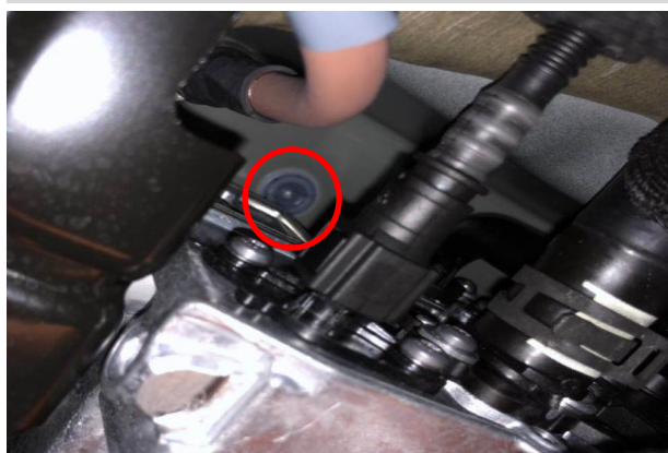
左穿线孔：电机线从车底此孔位穿进车身内部
