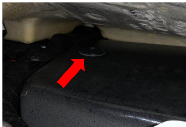
左穿线孔：如图此处孔位为左穿线孔
