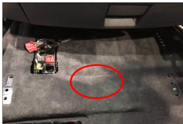
安装 ECU：在副驾驶座椅底下找到放置 ECU 的位置用 3M 胶固定（圆圈）；
